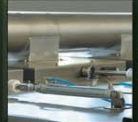
Pinömatis sistemle otomatik açılan dolum kapakları
