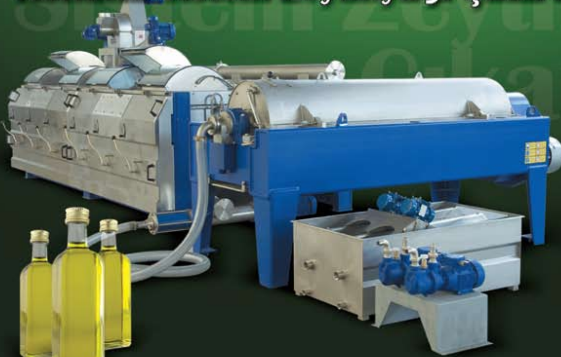
Dolu mil ve lamadan kaliteli malaksör karıştırıcısı
