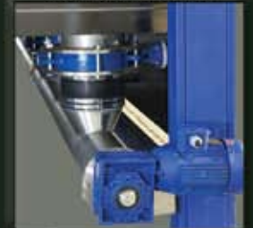
Otomatik panodan açılıp kapanan pinömatis boşaltım kapakları
